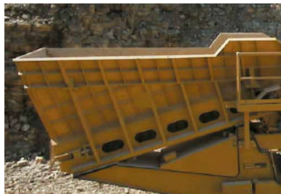
Tolva de alimentación & Cinta de alimentación a láminas
