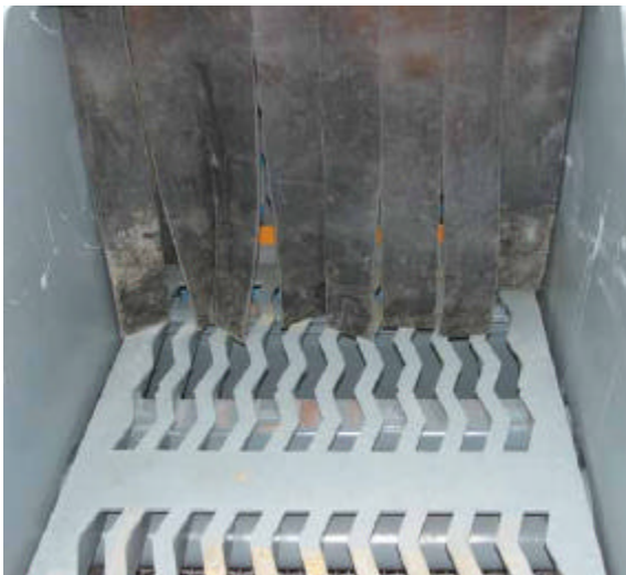
Criba de alto rendimiento de 2 pisos para carga pesada (Grizzly)
