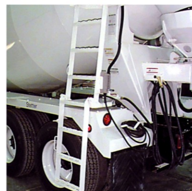
Escalera Posterior Nuevo diseño de escalera de dos secciones inclinada hacia fuera para mayor seguridad y facilitar la subida de los operadores.
