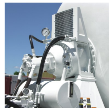
Reservatorio Hidráulico Largo reservatorio hidráulico con control visual facilitado. Todo el aceite es filtrado con un filtro de 10 micrones and esfriado con un robusto ventilador eléctrico de control automático.
