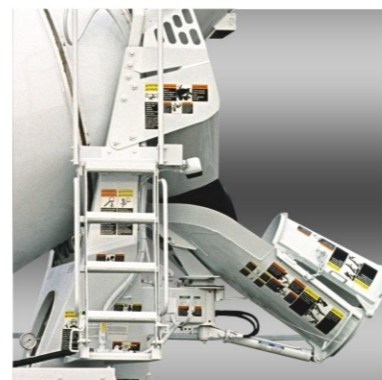
Tolva de Descarga Nuevo diseño de tolva, incrementado en un 20% y con ángulo de inclinación de 45° para facilitar la limpieza y mejorar la descarga.
