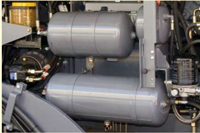
En la extendedora se han integrado depósitos de aire comprimido con una capacidad de 30, 20 y 10 litros.
