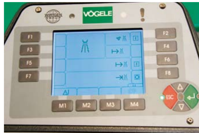
En la pantalla ErgoPlus pueden seleccionarse los prácticos programas „Inicio de la obra” y „Fin de la obra”.
