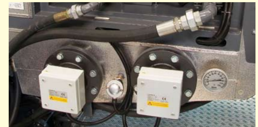
La calefacción de la emulsión (2 x 7 kW) puede regularse entre 0° C y 80° C.
