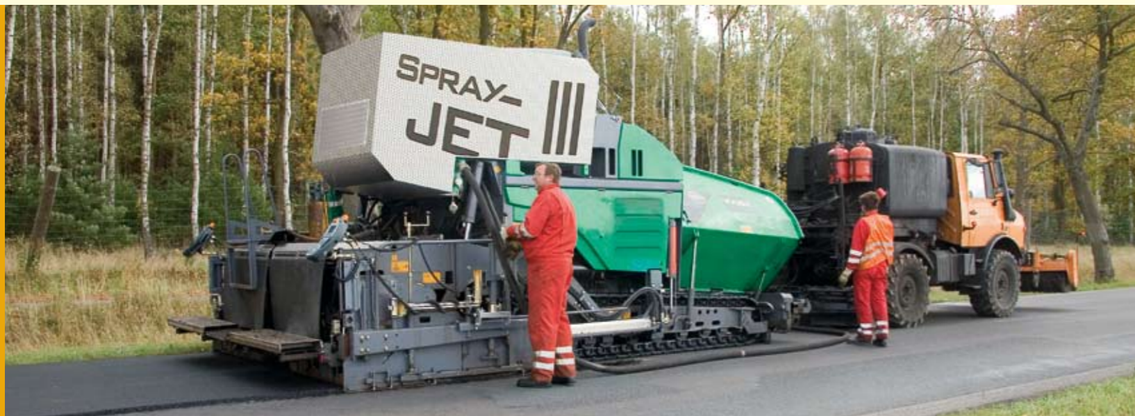
La extendidora, preparada para el riego, es accionada por un motor PERKINS del tipo 1106D – E66TA con una potencia de 129,6 kW. El motor dispone de un compresor de aire inteligente, que puede generar una presión máxima de 10 bar para abrir y cerrar las boquillas de riego.
