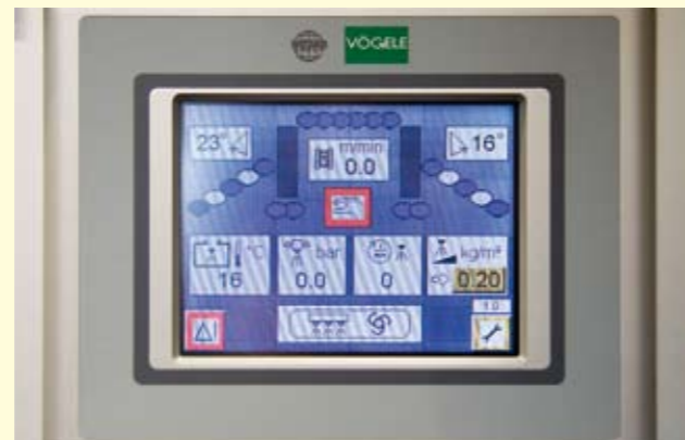
En la pantalla táctil a color, el operador obtiene todas las informaciones importantes y puede indicar de forma sencilla la cantidad de riego deseada.
