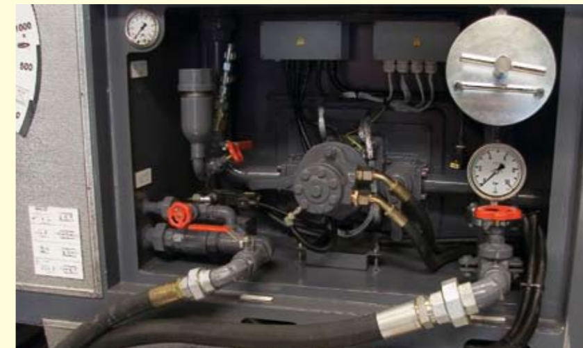
Gracias a la bomba calentada, la emulsión circula en el depósito garantizando así un estado permanentemente homogéneo.
