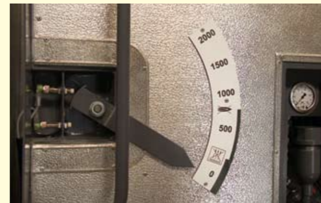
El depósito de emulsión puede llenarse con un total de 2000 litros de emulsión asfáltica.
