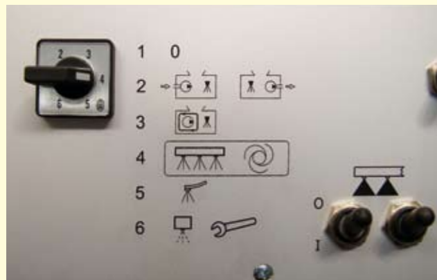
Práctico y sencillo: Con el robusto interruptor de trabajo se puede ajustar, por ejemplo, el funcionamiento de circulación y el sistema automático de riego.
